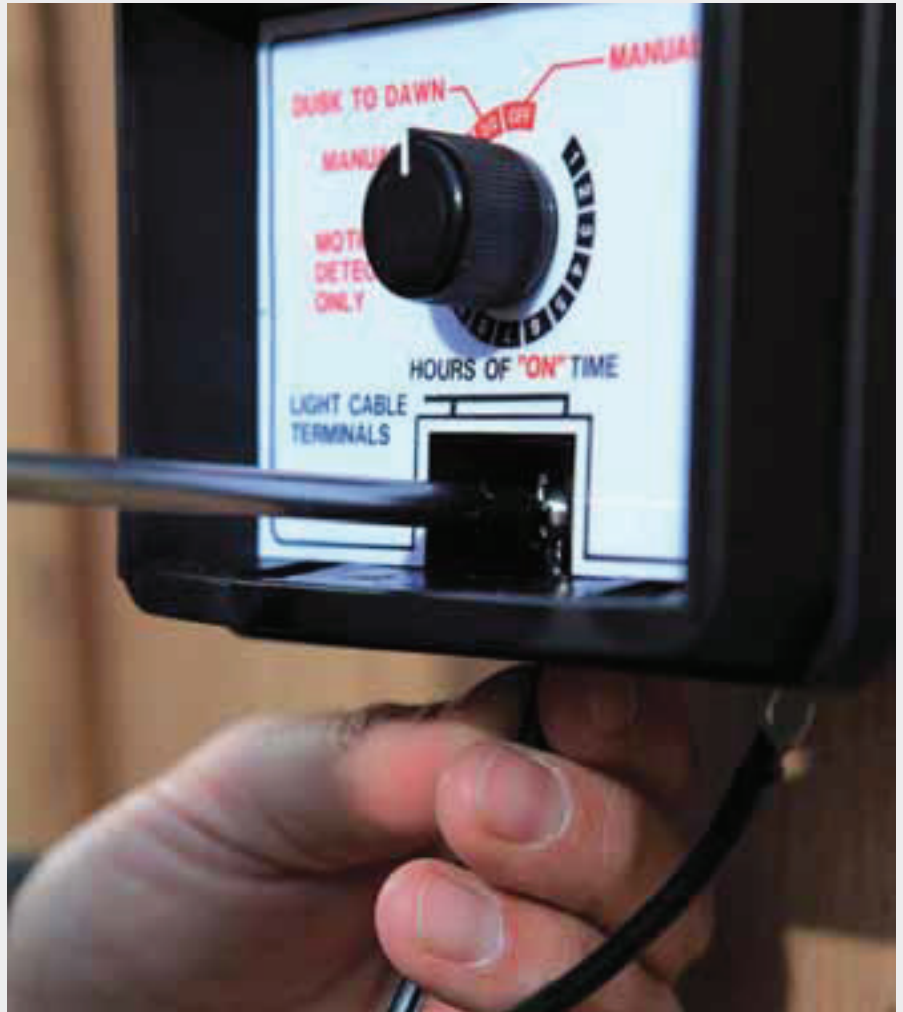
Gebruik altijd kabelschoenen wanneer je de kabel op de trafo aansluit
